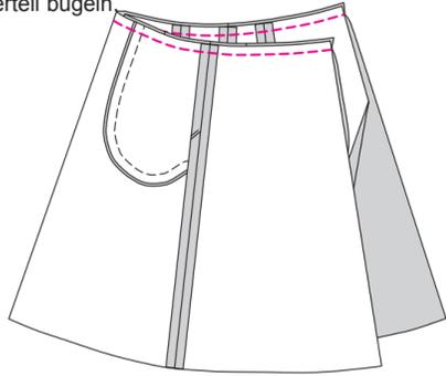
16. Wenn Sie einen normalen Reißverschluss einsetzen, bitte dieser Anleitung folgen. Möchten Sie einen nahtverdeckten einsetzen, so folgen Sie bitte der Anleitung des Herstellers. Die rückwärtige Mittelnaht rechts auf rechts stecken, die Taillennähte und Ausschnittnähte treffen aufeinander, die Punkte (= Reißverschlussenden) sind bündig. Von der Unterkante bis zum Punkt steppen, Naht sichern und die restliche Strecke bis zur Oberkante des Kragenstegs heften.
