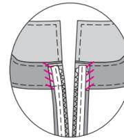
17. Die rückwärtigen Blenden rechts auf rechts entlang rückwärtigen Mitte aufeinander stecken. Steppen und die Nahtzugaben auf 6 mm zurückschneiden. Nahtzugaben auseinander bügeln.
