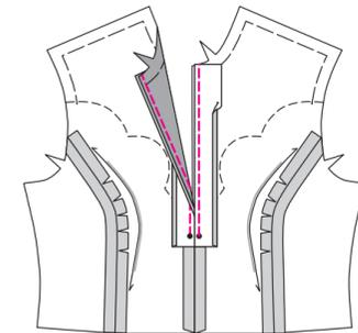
Die Leiste nach außen legen, die Nahtzugaben in die Leiste bügeln. Entlang der Faltnie links auf links falten. Von außen, umgefaltete Kante der rechten Leiste über die Nahtzugaben legen, die Naht ist verdeckt, die linke Leiste wird nicht mitgefasst. Die Leistennaht knappkantig zur Naht und zur Bruchkante absteppen.
