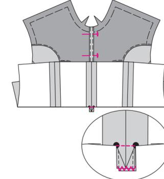
6. Die rückwärtigen Seitenteile entlang der rückwärtigen Teilungsnaht auf die Rückenteile aufsteppen, die Passzeichen treffen aufeinander, die Kanten sind bündig. Die rückwärtigen Nahtzugaben, wo nötig, entsprechend einschneiden.
